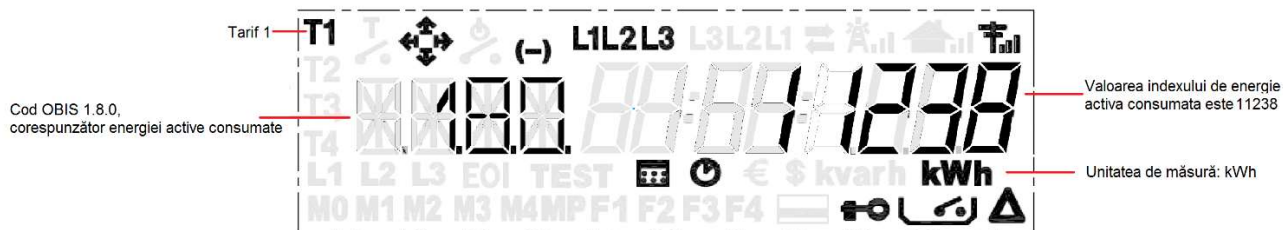
2.6.3 Imagine ansamblu afișaj contor monofazat MTR 1000 cu afișare index
