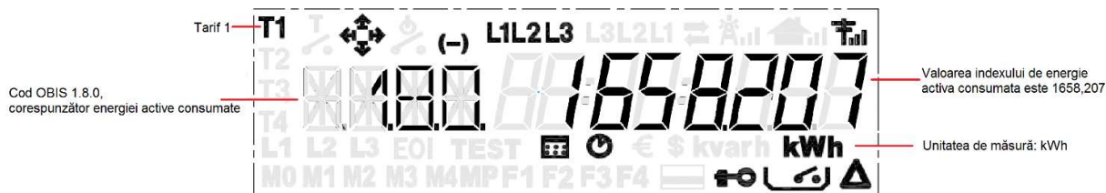
2.7.3 Imagine ansamblu afișaj contor trifazat MTR 3000 cu afișare index
